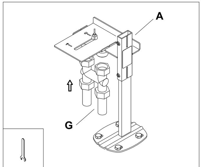
Heizungsrohre nach dem Stand der Technik verlegen und mit handelsüblichen Anschlussverschraubungen (G) am Spülbogen der Montageschablone (A) anschließen.
